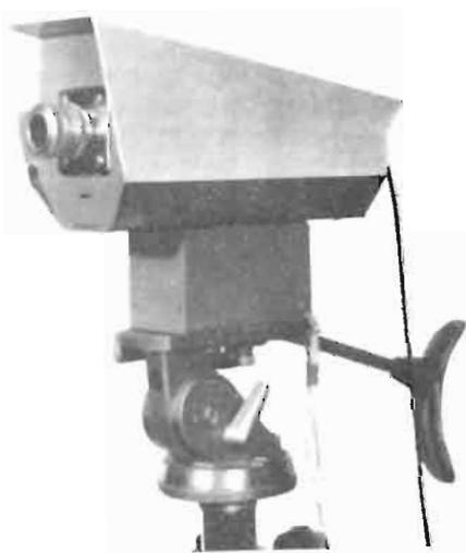
Prototipo sperimentale della telecamera a transistor.
